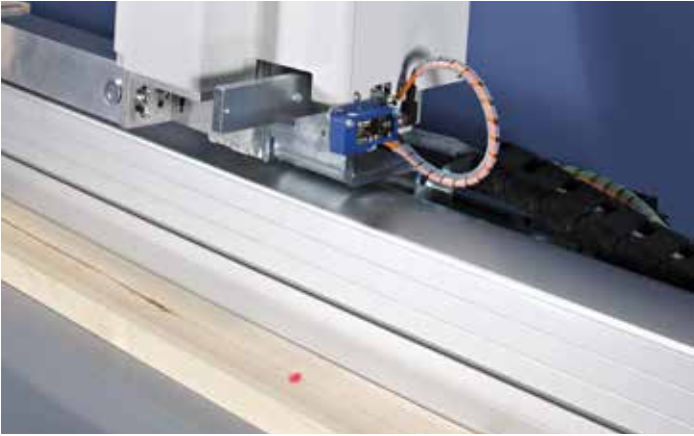
Détail du pousseur avec capteur de mesure de la pièce
